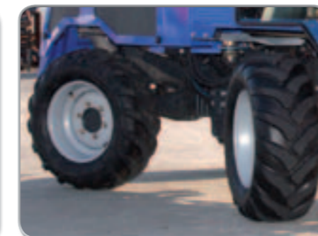
Trelleborgbereifung: 1540 mm Außenbreite
