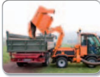
Hochentleerung von 230 cm und Überstand von 50 cm
