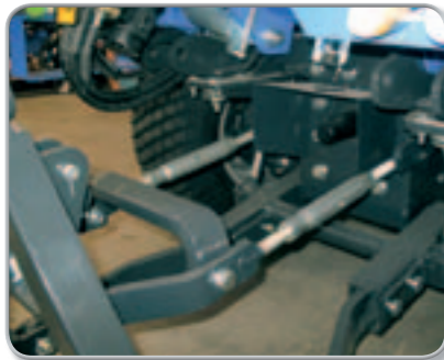
Mechanische Getriebezapfwelle mit Schutzabdeckung, vorn
