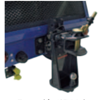
Zugmaul für ISEKI-Anhänger mit 2 Tonnen Nutzlast
