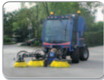
Kehrmaschine mit Kehr-Saugereinheit
