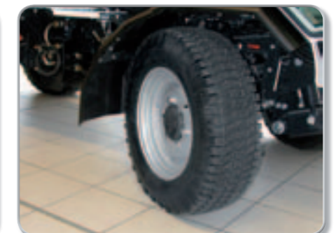
Schmale Straßenbereifung: 1410 mm Außenbreite
