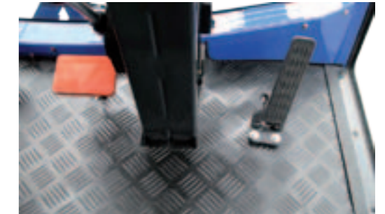
Großräumiger Fußbereich mit Fußbremse (links) und Servopedal (rechts)
