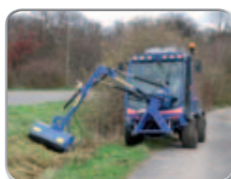
Mit dem Schlegelmäher und Schlegelauslegermäher gegen Wildwuchs
