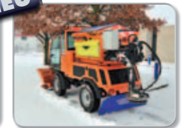
Das Multi-Konzept ermöglicht den Anbau eines Feuchtsalzstreuers von Küpper Weisser und Keilschild
