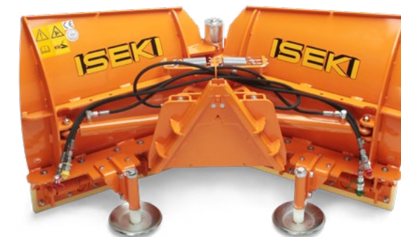
V-Schild mit zwei verstellbaren Scharrblättern.
